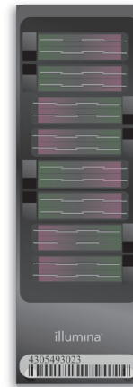
Figure 1 : Puce Infinium CytoSNP-850K v1.4 BeadChip – La puce Infinium CytoSNP-850K v1.4 BeadChip pour huit échantillons procure des gènes pertinents du point de vue de la cytogénomique pour les recherches constitutionnelles et cancérologiques et comporte du contenu provenant de l'ICCG et du CCMC.
