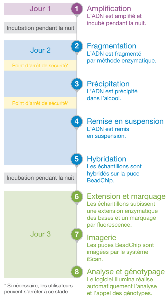
Figure 8 : Flux de travail Infinium pour 8 échantillons – Le flux de travail Infinium propose un flux de travail rapide de trois jours avec une durée de manipulation minimale.
