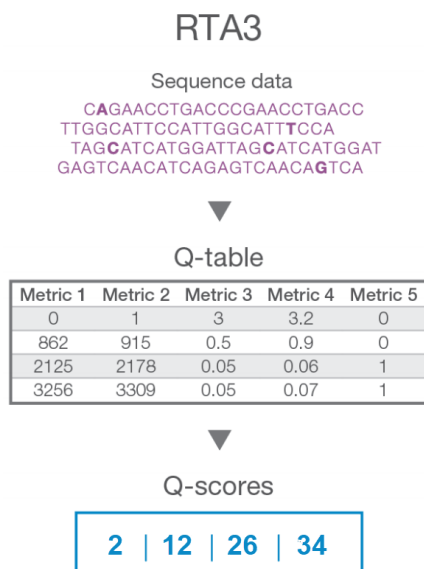
24 ábra Egyszerűsített Q-pontozás RTA3-mal
