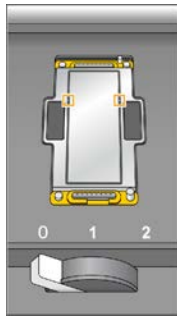
Figura 14 Inspección de los orificios de vacío
