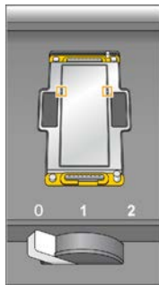
Figura 19 Inspección de los orificios de vacío
