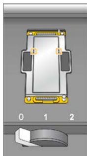
Figura 8 Inspección de los orificios de vacío
