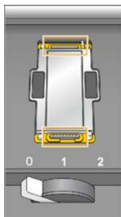
Figura 22 Retirada de las juntas usadas de los distribuidores
