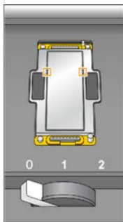
Figura 14 Inspección de los orificios de vacío
