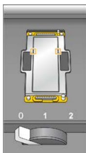
Figure 14 Inspecter les trous de décompression
