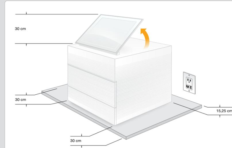
Der braune Versandkarton hat ein Gewicht von 21 kg. Das Gerät wiegt 16 kg. Zum Heben beider Komponenten werden zwei Personen benötigt.
