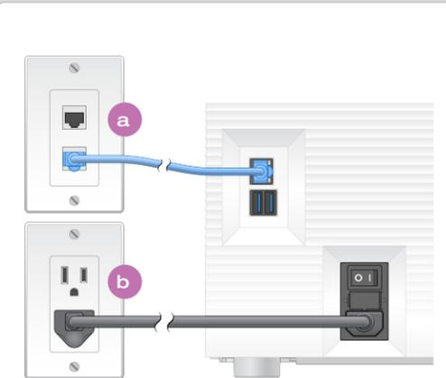
**a** Um das iSeq 100-System für eine kabelgebundene Netzwerkverbindung zu konfigurieren, schließen Sie das Ethernet-Kabel an einen Ethernet-Anschluss an.
