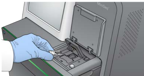
Figure 12 Installation de la Flow Cell sur la platine
