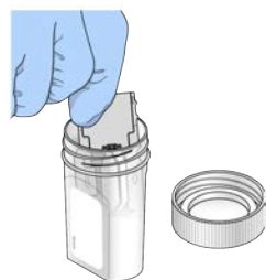
Figura 9 Rimozione della cella a flusso
