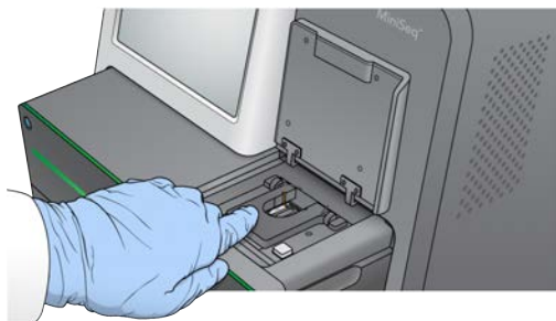
Рисунок 19. Закрывание защелки проточной кюветы
