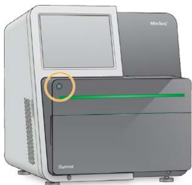
Рисунок 8. Кнопка питания расположена на передней панели прибора
