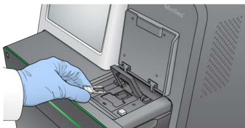
Рисунок 12. Установка проточной кюветы на площадку
