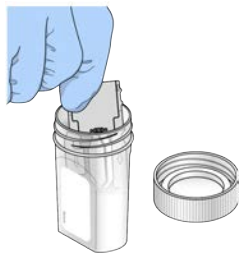
Рисунок 9. Извлечение проточной кюветы
