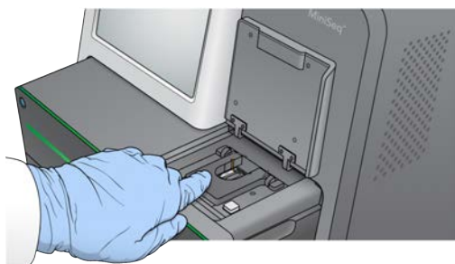
Рисунок 13. Закрывание защелки проточной кюветы
