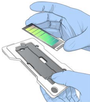
Figur 19 Overførsel af BeadChip til adapteren
