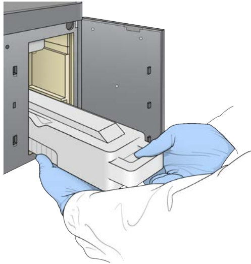
Figur 14 Udtagning af beholderen med brugte reagenser
