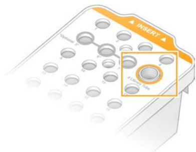
图 20 装入位置 8 处的文库试管（已取下管帽）
