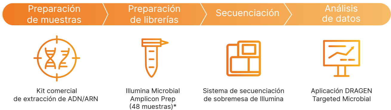
Figura 2: Flujo de trabajo de Illumina Microbial Amplicon Prep: en un flujo de trabajo optimizado, las librerías microbianas se preparan con el kit Illumina Microbial Amplicon Prep, se secuencian en cualquier sistema de secuenciación de sobremesa de Illumina y se analizan en la aplicación DRAGEN Targeted Microbial para la detección, la llamada de variantes y la tipificación de estirpes. *El kit incluye índices para la preparación de librerías. Los oligonucleótidos del cebador se adquieren por separado.
