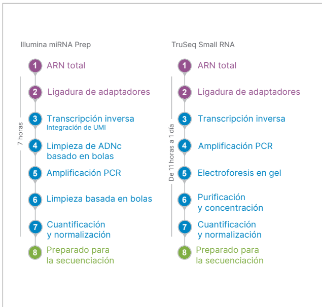
Figura 3: Comparación del flujo de trabajo de Illumina miRNA Prep y TruSeq Small RNA
