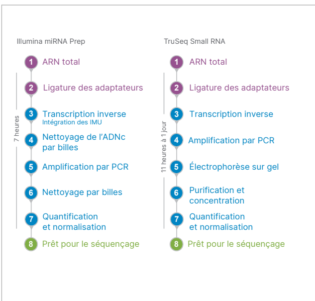
Figure 3 : Comparaison du flux de travail d'Illumina miRNA Prep et de TruSeq Small RNA
