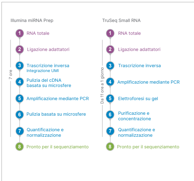
Figura 3: confronto tra i flussi di lavoro di miRNA Prep e di TruSeq Small RNA di Illumina
