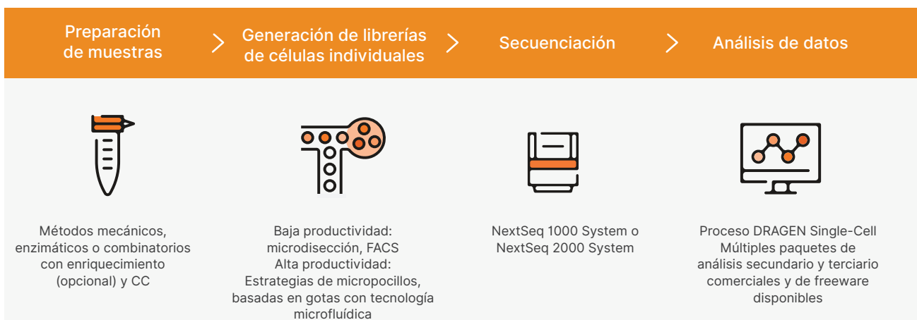
Figura 2: Flujo de trabajo de scRNA-Seq de NextSeq 1000 y NextSeq 2000. NextSeq 1000 System y NextSeq 2000 System forman parte de un flujo de trabajo de NGS integrado que abarca la preparación inicial de tejidos mediante el aislamiento de células individuales y la preparación de librerías, la secuenciación y el análisis principal, y la visualización e interpretación de datos.
