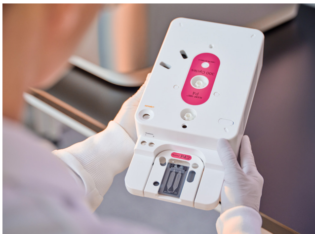
Figura 3: Cartucho de reactivos NextSeq 1000 y NextSeq 2000. El cartucho integrado incluye reactivos, fluídica y el soporte de residuos. Solo tiene que descongelar y preparar el cartucho de reactivos, insertar la celda de flujo, cargar la librería y colocarla en el instrumento.
