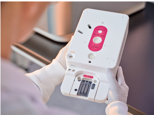
Figura 3: cartuccia di reagenti NextSeq 1000 e NextSeq 2000. La cartuccia integrata include reagenti, fluidica e supporto per gli scarti. È sufficiente scongelare e preparare la cartuccia di reagenti, inserire la cella a flusso, caricare la libreria e posizionarla nello strumento.
