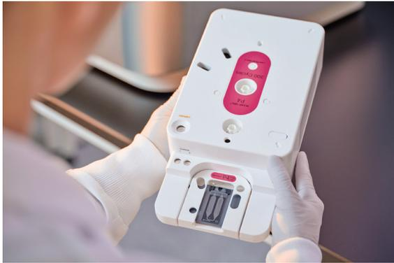
カートリッジは、試薬、フルイディスク、廃液ホルダーが一体化されています。試薬カートリッジを融解して準備し、フローセルを挿入してライブラリーをロードし、装置にセットするだけです。
