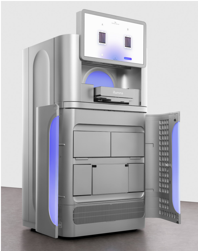
Figura 5: Operação direta: Muitos recursos dos sistemas NovaSeq X e NovaSeq X Plus são projetados para simplificar o fluxo de trabalho de sequenciamento, incluindo uma interface de tela sensível ao toque de alta resolução e cartuchos fáceis de usar, contendo reagentes prontos.
