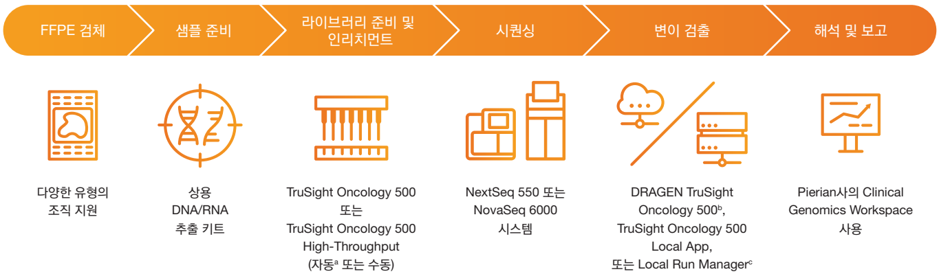
그림 2: TruSight Oncology 500 워크플로우 — TruSight Oncology 500 및 TruSight Oncology 500 High-Throughput은 핵산 준비부터 변이 검출에 이르는 기존 워크플로우를 4일 안에 완료 가능.
